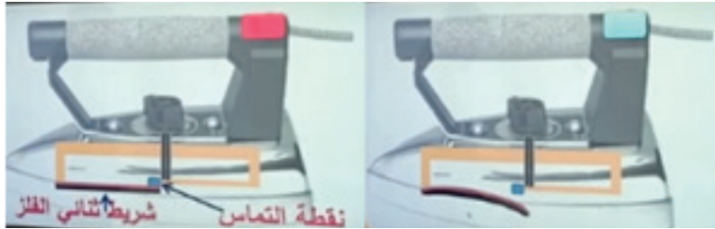
الثرموستات في دارة المكواة الكهربائية
