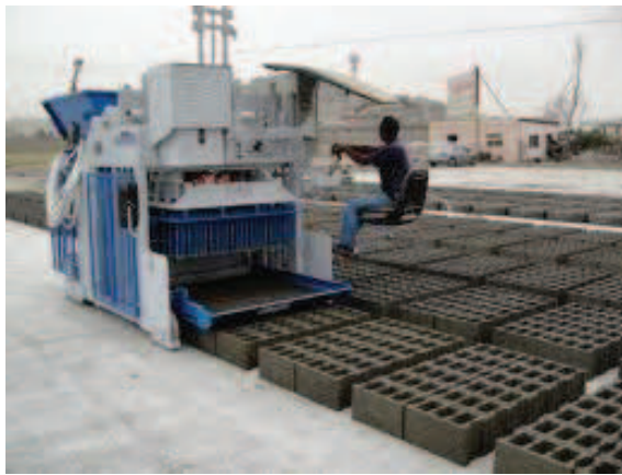
صناعة الطوب آلياً (زرّاعة الطوب)
